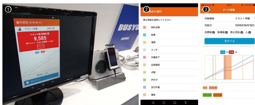
①「生産性見え太君」の画面。加速度センサーを利用して加工機の動作回数を記録／②生産が止まった状態である程度時間が経つと、「停止理由」を聞かれる／③作業者が自分で設定した“目標”の生産ペースと実績、「停止理由」をグラフ化して表示
