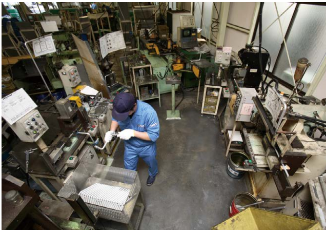
「1個流し生産」の現場。U字型に自社開発の「ミニ設備」や治工具を配置し、多品種少量の部品の生産性を高めている
