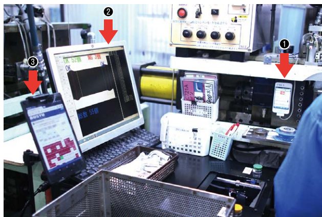
現場のIoT活用事例。加工設備に①「生産性見え太君」がインストールされたiPod touchが取り付けられ、②画像検査装置のPC端末と③BIMMSの端末（タブレット端末）が設置されている
