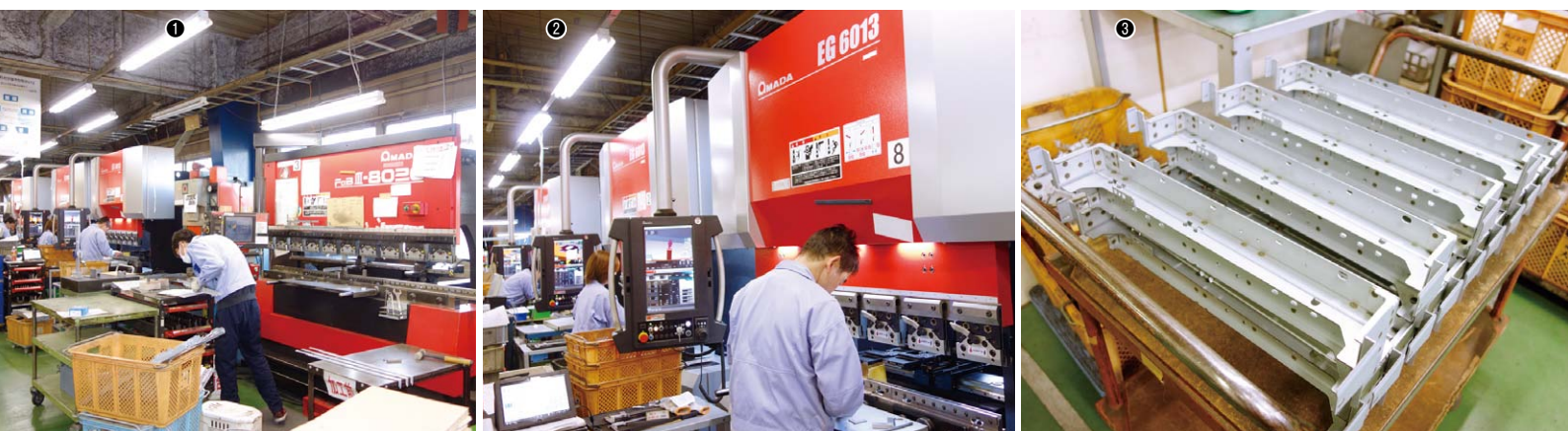
①曲げ工程には8台のネットワーク対応型ベンディングマシンが設置されている／②ベンディングマシンEG-6013が3台並ぶ／③曲げ加工された機構部品
