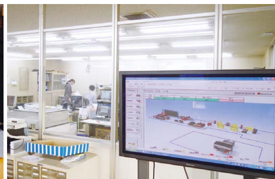
工程管理板(右)で設備の稼働状況を確認できる
