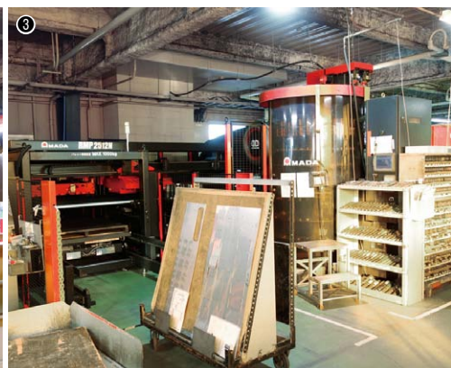
①ファイバーレーザー複合マシンLC-2512C1AJ+RMP-2512N / ②2台のパンチングマシン(左)に材料を供給できるように改良を加えた自動倉庫MARS(右) / ③パンチングマシンEMZ-358NTP+RMP-2512N+MARS
