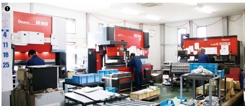
①曲げ工程。ACIES-AJ導入により曲げ工数が不足することを予測してEG-6013(左端)を新たに導入 ②ACIES-AJ導入に先立ち、2017年1月にあらかじめ導入したEG-6013
