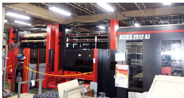
都市型のアーバン工場のため、設置スペースにも天井高さにも制約があり、据え付けが大変だったという。3段の素材棚・製品棚の2連棚仕様となっている
