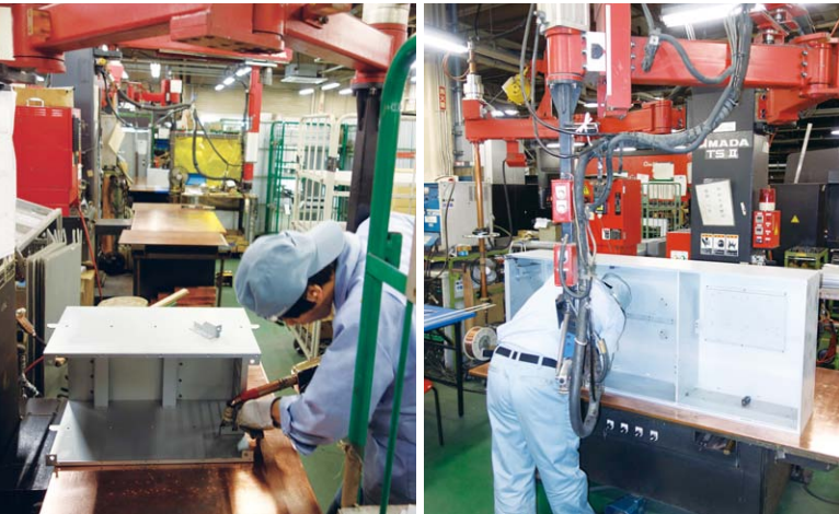
左：テーブルスポット溶接機を3台保有している 右：テーブルスポット溶接機による券売機の筐体溶接作業
