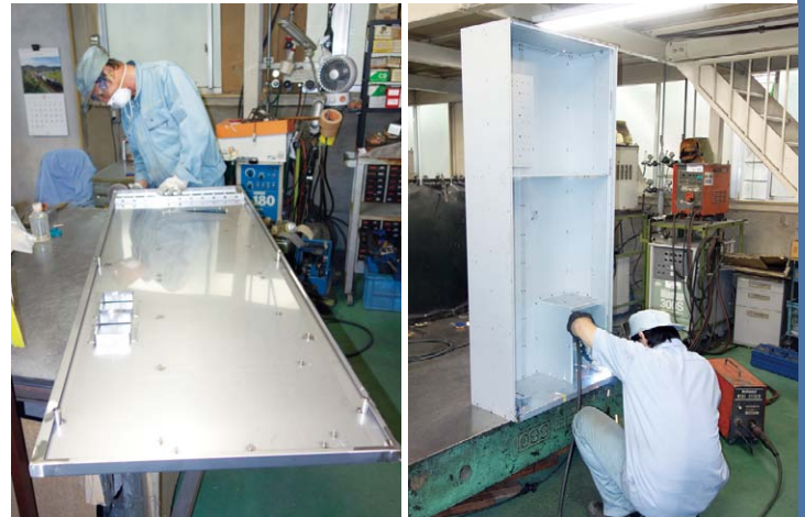
左：理化学用機器のステンレス筐体カバーの溶接 右：券売機筐体の溶接
