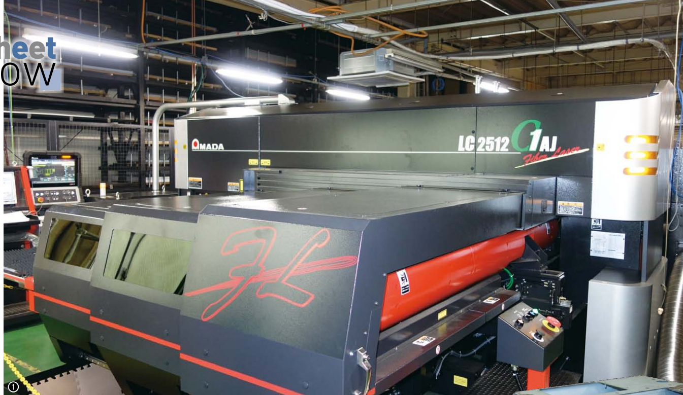
① ファイバーレーザー複合マシンLC-2512C1AJ+RMP-2512NTK+MARS ② バスの運賃箱のシャーシ
