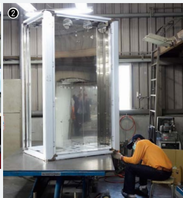
①曲げ加工エリア／②ステンレス製の大型盤管体の溶接作業／③台湾全土の信号機用の屋外設置型のカラフルな制御盤も生産している
