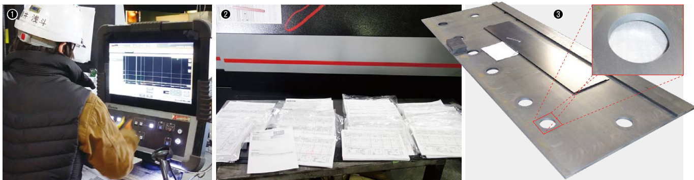
① ENSIS-AJのコンソールに搭載したAMNC 3i。操作性が向上している／② ENSIS-AJで加工する製品の作業指示書が並べられている／③ (左) ENSIS-AJで加工したSPHC・板厚16mmの製品／(右) 切断面の面粗度も良い
