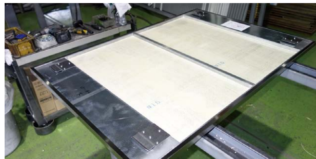
内壁材として施工を簡便にするためステンレス製フレームを加工して組み立てている
