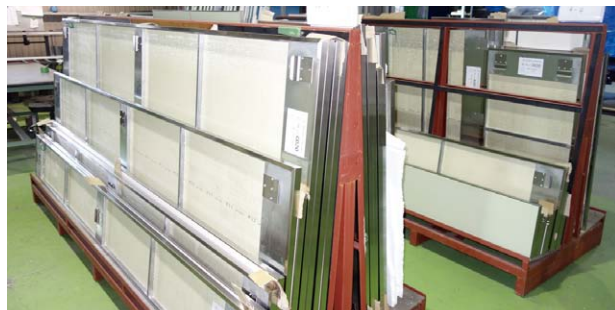
セラミック複合材は病床数が多い大型病院で採用されるケースが多い。内壁材として物件ごとに加工、組み立てて出荷している
