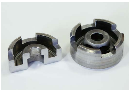
ナックルリンクプレスPDL-400(右)で加工された自動車向け機能部品(左)。絞り・板鍛造・型内ねじ転造(写真は転造加工前)を1ストロークで完結させている
