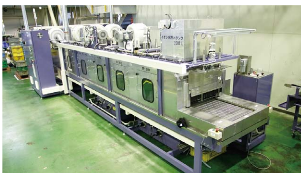
サーボプレス3台のタンデムラインは、自社製品の電解イオン水洗浄装置（写真）と直結している
