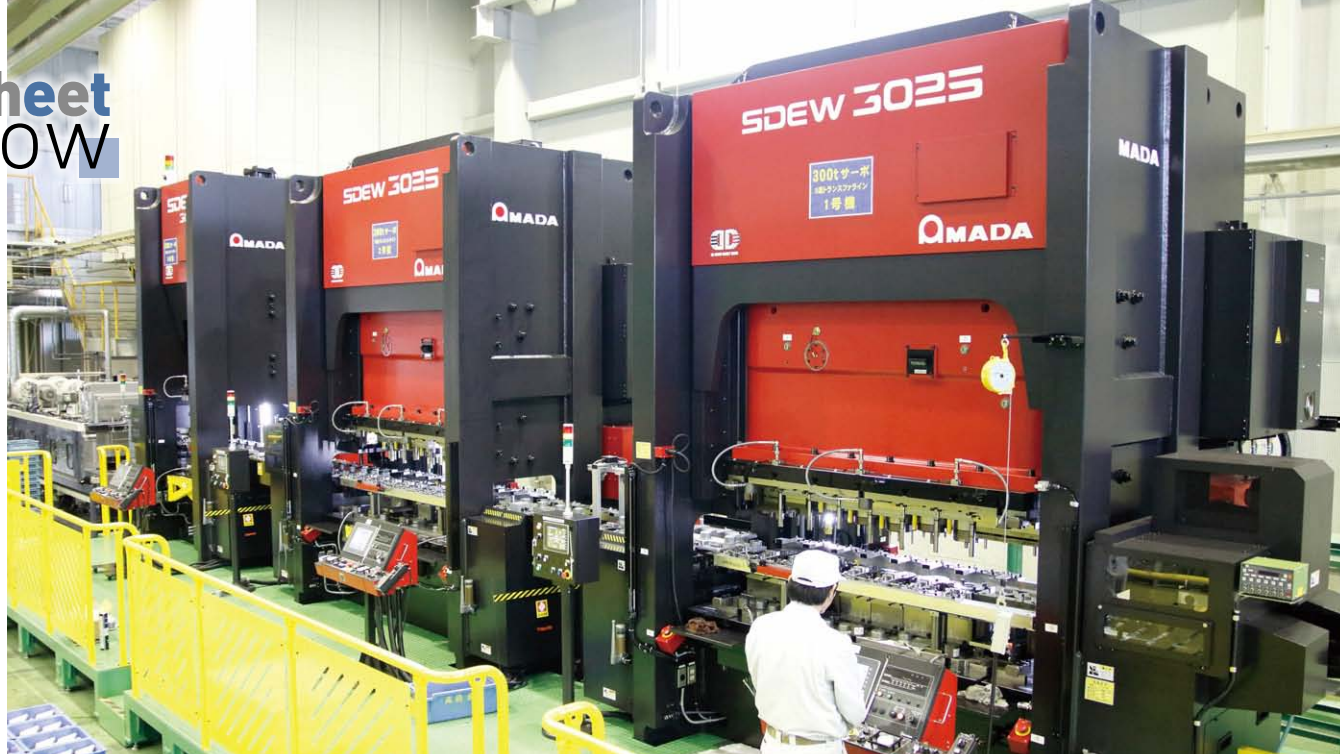
サーボプレスSDEW-3025×2台とSDE-3030をトランスファー装置で連結したタンデムライン。車載用モーターケース（ZAM・板厚2.3mm、1.6mm）の生産に対応する。当初は大型トランスファープレスによる加工を想定していたが、ダウンサイジングと工程分割により、短期立ち上げ・安定品質加工などのメリットが生まれた
