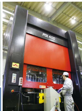
ナックルリンクプレスPDL-400(右)で加工された自動車向け機能部品(左)。絞り・板鍛造・型内ねじ転造(写真は転造加工前)を1ストロークで完結させている
