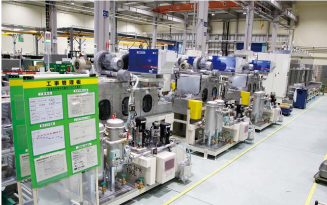
自社商品の電解イオン水洗浄装置の組立工程
