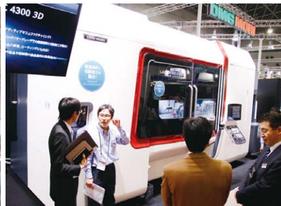
DMG森精機は、ハイブリッド複合加工機「LASERTEC 4300 3D」を出展。積層造形の方法は「LMD方式」を採用
