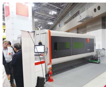
Bystronic (スイス) が出展したファイバーレーザーマシン「BySprint Fiber」(6kW)
