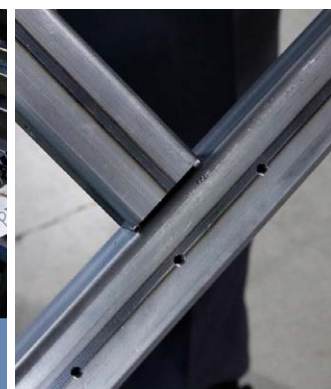
①レーザーマシンFO-MII RI 3015のロータリーインデックス装置／②FO-MII RIで切断した角パイプ／③切り欠きを入れた箇所 に角パイプをはめ込み、フレームを構成していく
