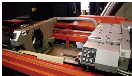
①レーザーマシンFO-MII RI 3015のロータリーインデックス装置／②FO-MII RIで切断した角パイプ／③切り欠きを入れた箇所 に角パイプをはめ込み、フレームを構成していく
