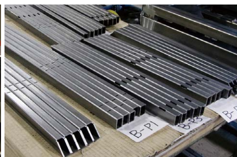
①レーザーマシンFO-MII RI 3015のロータリーインデックス装置／②FO-MII RIで切断した角パイプ／③切り欠きを入れた箇所 に角パイプをはめ込み、フレームを構成していく
