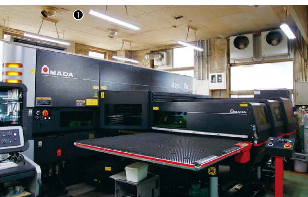
① 2015年に導入したファイバーレーザ複合マシンLC-2512C1AJ／②高精度な曲げ加工を実現する曲げ工程／③曲げ加工製品
