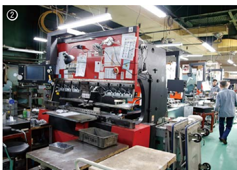
① 2015年に導入したファイバーレーザ複合マシンLC-2512C1AJ／②高精度な曲げ加工を実現する曲げ工程／③曲げ加工製品
