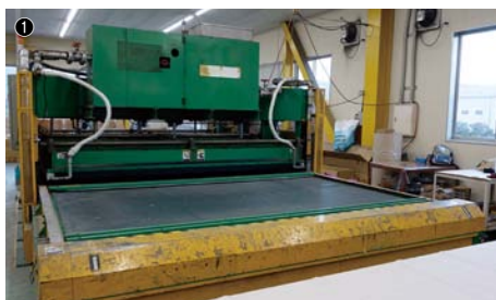
① 自社開発のホット&コールドプレスマシン。ハニカム構造のアルミ材料を温間圧着する／② サンドイッチ構造のアルミパネル。材料を特型に載せシートで密封したあと真空状態にし、型に合わせて形状を転写させる工法を確立。自由な曲面を備えた成形加工が可能／③ 成形加工された新幹線デッキのパネル
