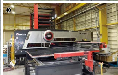
①専用の溶接治具を用い溶接を行う／②日立製作所が英国から受注したIEP（都市間高速鉄道計画）向け鉄道車両に使われる、運転台席後方のパネル／③パンチ・レーザ複合マシンEML-3610NT+ASR-510M+TK+IJP
