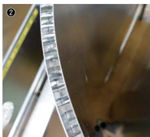
① 自社開発のホット&コールドプレスマシン。ハニカム構造のアルミ材料を温間圧着する／② サンドイッチ構造のアルミパネル。材料を特型に載せシートで密封したあと真空状態にし、型に合わせて形状を転写させる工法を確立。自由な曲面を備えた成形加工が可能／③ 成形加工された新幹線デッキのパネル
