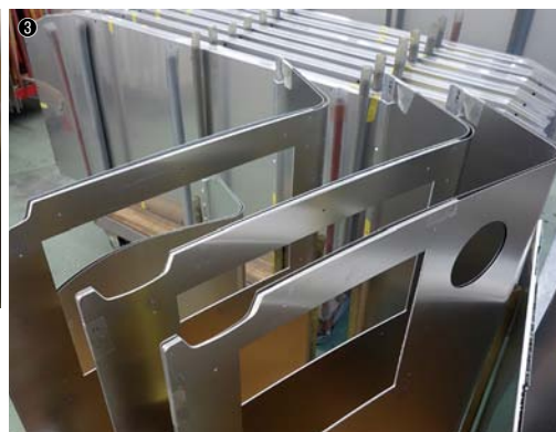
① 自社開発のホット&コールドプレスマシン。ハニカム構造のアルミ材料を温間圧着する／② サンドイッチ構造のアルミパネル。材料を特型に載せシートで密封したあと真空状態にし、型に合わせて形状を転写させる工法を確立。自由な曲面を備えた成形加工が可能／③ 成形加工された新幹線デッキのパネル
