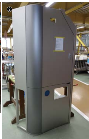
① 成形加工を終えたあと、表面に仕上げ用のシートを貼る ② 化粧シートを貼ったパネルで組み上げた、N700Aの配電盤ユニットパネル
