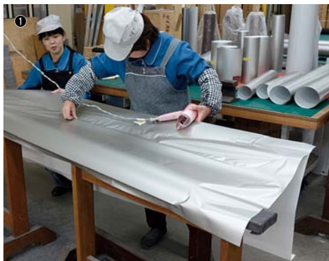
① 成形加工を終えたあと、表面に仕上げ用のシートを貼る ② 化粧シートを貼ったパネルで組み上げた、N700Aの配電盤ユニットパネル
