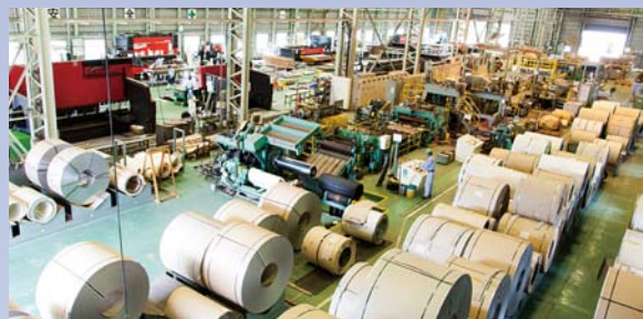
手前がコイル材からレベラー・スリッターで板材に加工する1次加工エリア、奥がシャーリング・レーザ・ベンディングまでの2次加工エリア
