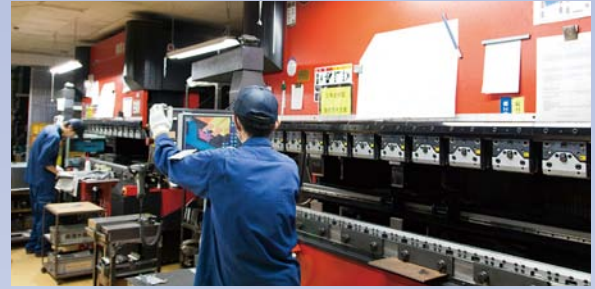
ベンディングマシンHDS-8025NTを3台設備し、どのマシンでも同じ操作、同じ品質で加工できる体制を構築
