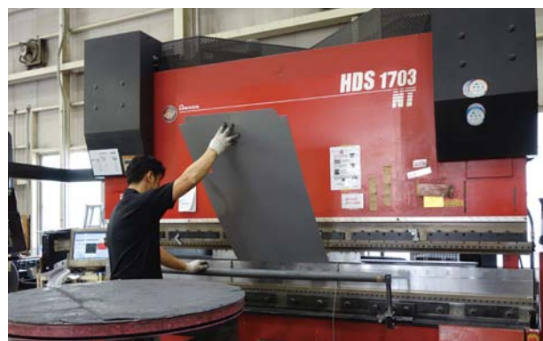
ブランク加工後のパネルや枠は、HDS-1703NTなどで曲げ加工を行う
