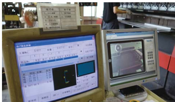
ベンディングマシンの横にはタッチパネル式の端末を設置し、曲げ加工支援情報を現場で確認できる
