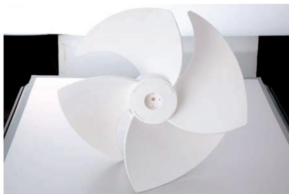
試作加工したファンの大型粉末造形品
