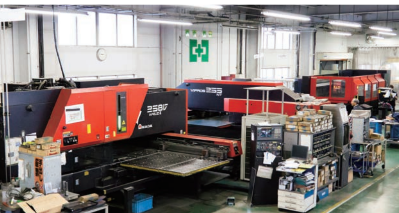
ブランク工程。手前からパンチ・レーザ複合マシンAPELIOⅢ-258V、パンチングマシンVIPROS-255NT+MP-1225NJ、レーザマシンFO-2412NT+LST-2412FO
