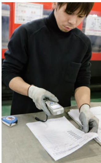
バーコード端末で作業指示書を読み取り、着手完了を記録している
