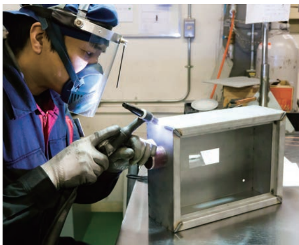
溶接工程で筐体の溶接を行う
