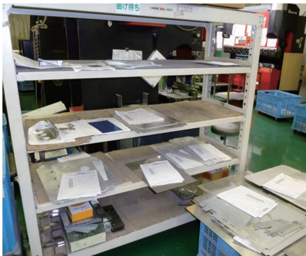
バッファーエリアに置かれた曲げ加工待ちの blanks。顕著な多品種少量生産で、バーコード付き作業指示書で管理している
