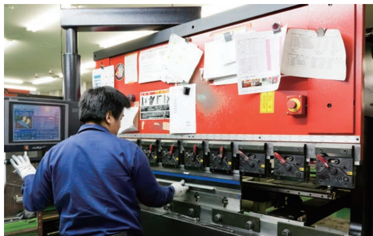
曲げ工程は、Dr.ABE_Bendが作成した曲げ加工データを読み出して加工する
