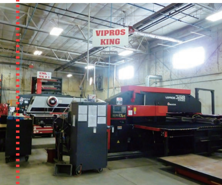
パンチングマシンVIPROS-358L(手前)と、 パンチ・レーザー複合マシンEMLK-3610NT+TK+ETG-450(奥)
