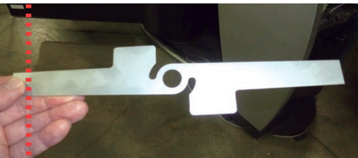
FOL-3015AJで加工した鋼板・板厚3mm
