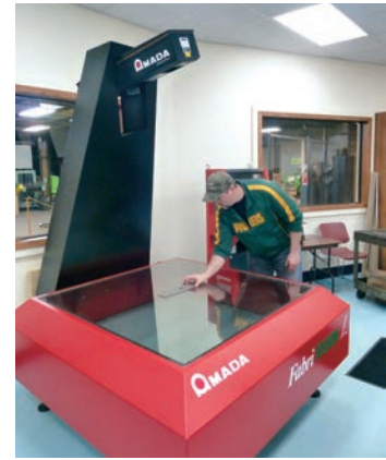
インスペクションルームでは、画像検査装置Laser QCによるブランク加工品の初回ロットの抜き取り検査を行う
