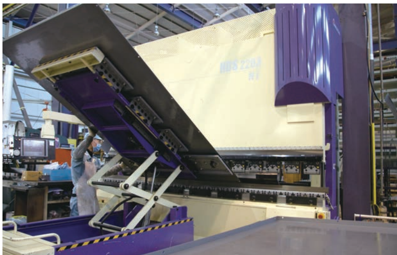
HDS-2203NTでは、追従装置を用い長尺板の曲げ加工を行う
