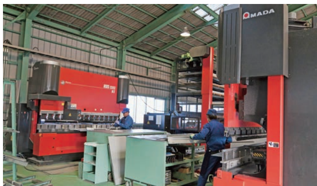
再建後の三光総業の工場内。パンチングマシン EM-2510NT、ベンディングマシン HDS-1303NT × 2台、RG-M2 3512 を新たに導入した。プログラム工程(右下)はデータをすべて消失したため、すべてゼロからデータをつくりなおさなくてはならなかった。現在では加工データを外部に預託するなど BCP/BCM 対策を採っている
