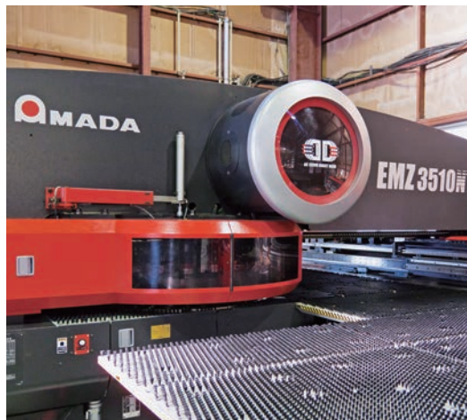
移転・再建後のみやぎ金属工業の工場建屋。みやぎ金属工業が再建に際して新たに導入したパンチングマシン EMZ-3510NT(左)とベンディングマシン HDS-1303NT(右)。3社とも新たに導入した設備はすべてアマダの「特別条件」を利用したかった」(相澤社長)
