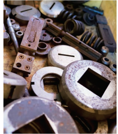
6月以降、みやぎ金属工業の社員たちが黙々と磨いたという金型の一部。表面をどれだけ磨いても内側からサビが浮き出してくる。精度面で実用は難しいが「なかなか捨てられない」(相澤社長)という
