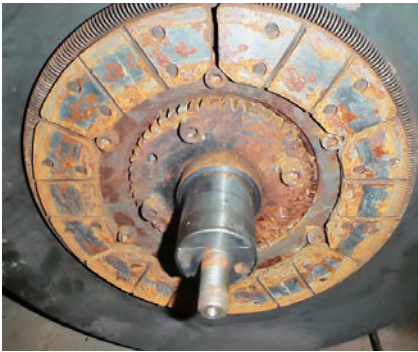
アマダの機械再生工場となった、みやぎ金属工業の工場内。全国のサービスマンが代わる代わる訪れて作業にあたった。海水に浸かってサビが付き、砂・ヘドロが細部に入り込んだ機械を分解し、洗浄と部品交換を行っていた
