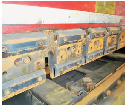
アマダの機械再生工場となった、みやぎ金属工業の工場内。全国のサービスマンが代わる代わる訪れて作業にあたった。海水に浸かってサビが付き、砂・ヘドロが細部に入り込んだ機械を分解し、洗浄と部品交換を行っていた
