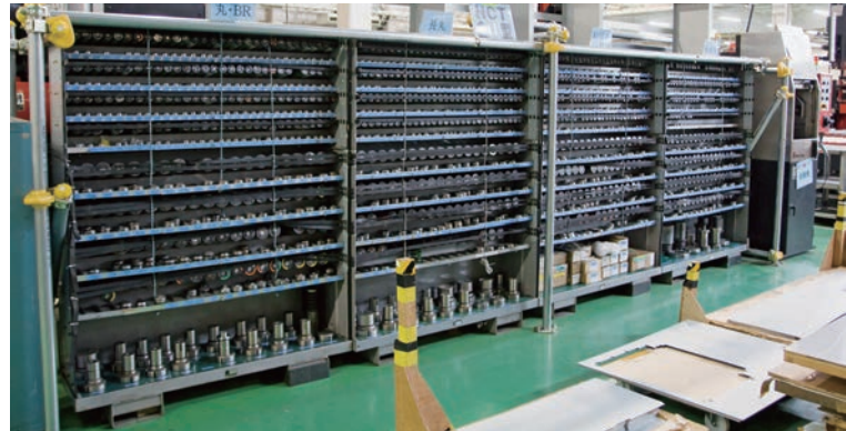
地震発生時に金型ラックから飛び出ないように、すべての金型にゴム製のストッパーを備えている
