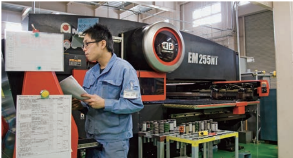
1,000種類以上の金型を保有するEM-255NTは、抜きから成形加工まで多様な加工に対応する
