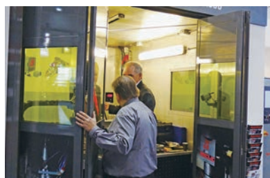
米国のプラズマ発生装置のメーカーである Hypertherm はファイバーレーザー発振器 (1.5kW・3.0kW) を自社開発。今回は自社製発振器を搭載できる「ZINSER 1225-1 Fiber Laser」を出展
