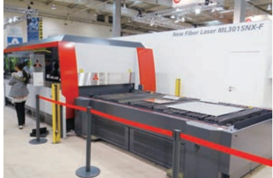
三菱電機はIPGと共同開発した2.5kWファイバーレーザー発振器を搭載したファイバーレーザーマシン「ML3015NX-F」を出展
