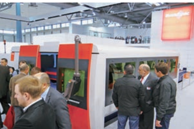
スイスの板金加工機メーカー Bystoronic は IPG 製発振器 (1 ~ 4kW) を搭載したファイバーレーザーマシン「BySprint Fiber」を出展
