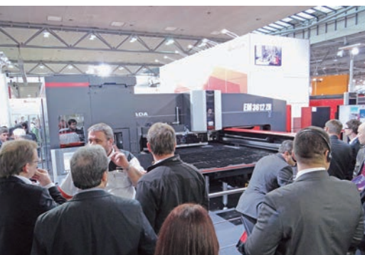
新型RZタレットと全面フルフラットのプラスチックを採用し、裏キスレス加工を実現するパンチングマシン「EM-3612ZRT」
