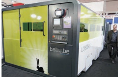
ベルギーの板金加工機メーカー Balliu は、Rofin 製発振器 (1.5kW) を搭載したファイバーレーザーマシン「ILD-1500PSf」を発表
