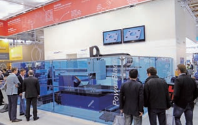
米国系のMesserは、IPG製発振器(3kW)を搭載した開先加工のできるファイバーレーザーマシンを出展
