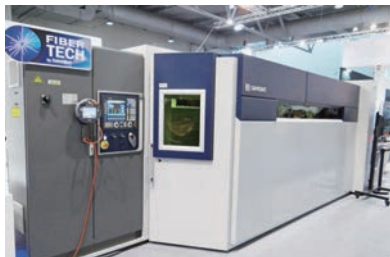
スペインの研削盤総合メーカー Danobat は Rofin 製発振器 (2kW) を搭載したファイバーレーザーマシン「IRIS」を発表
