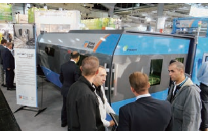
イタリアのPrimaは、IPG製発振器(2~3kW)を搭載できるファイバーレーザーマシン「platio fiber」を出展
