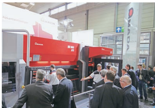
ATCのパンチホルダー・ダイホルダーを一新し、ステップベンド加工時の金型取替りを効率化したハイブリッド方式のベンディングマシン「HG-1003ATC」
