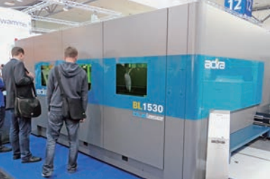
ポルトガルの板金加工機メーカー Adira は、Rofin 製発振器 (4kW) を搭載したファイバーレーザーマシン「BL-1530」を発表
