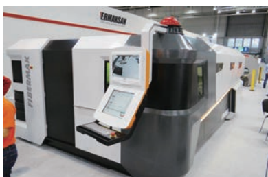
トルコの板金機械総合メーカー ERMAKSAN は IPG 製発振器 (2kW) を搭載したファイバーレーザーマシン「FIBERMAK」を出展
