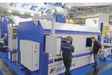
ドイツの Eckert は、500W から 6kW までのファイバーレーザー発振器を搭載できる「Diamondo Fiber Laser」を出展
