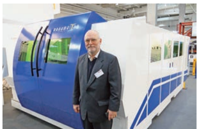
インドのSrahmastraは2004年に世界で初めてファイバーレーザー加工機を市場へ投入した。ダイヤモンドカッター用、産業用と展開し、IPG製発振器1.5、2、3kWをシリーズ化
