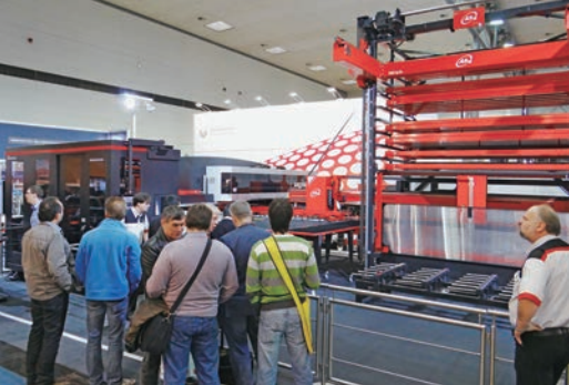
72時間連続稼働を実現するパンチ・レーザ複合マシン「ACIES-2515T」
