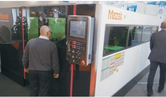
ヤマザキマザックは、IPG 製発振器 (2kW) を搭載したファイバーレーザーマシン「Optiplex 3015 Fiber」を発表
