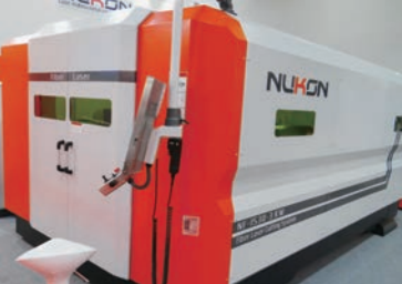
トルコの切断機メーカーNUKON LASERは、IPG製発振器(3kW)を搭載したファイバーレーザーマシン「NF-1530」を出展
