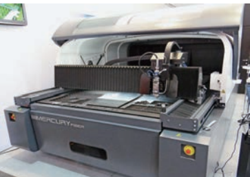
イタリアのSEI LASERは自社開発したファイバーレーザー発振器(1~2kW)を搭載した「Mercury Fiber 1530」を出展
