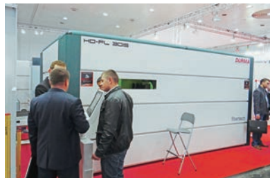
トルコの板金機械総合メーカー Durma は、Rofin 製発振器 (2kW) を搭載したファイバーレーザーマシン「HO-FL 3015」を出展
