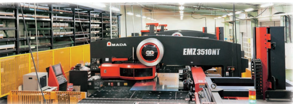
自動倉庫MARS(8列10段)と連動するパンチングマシンEMZが3台並ぶ(2台はPDC付き)
