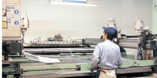
自社開発した「マイクロジョイントセパレータ」。シートネスティングされた製品のバラシ作業を自動化する
