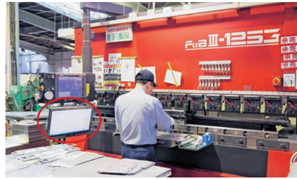
FBD III -1253NT による曲げ加工。作業指示書に印字された QR コードを読み込むと AMNC/PC 下のディスプレイに製品図面の PDF データが表示される
