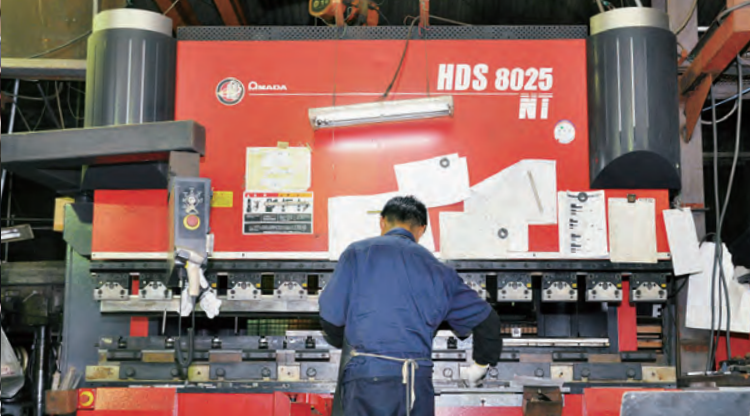
ベンディングマシンHDS-8025NTによる曲げ加工
