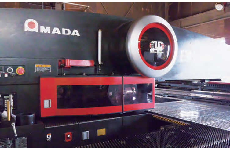
パンチングマシン EM-2510NT。ダレ面が必要となるような製品や成形加工で活躍し、OVS(原点自動補正装置)付きの FOL-AJ との複合加工にも対応する
