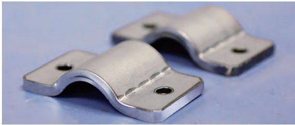
小径パイプの取付金具。レーザー加工で積層の特型を自作し、小径パイプや取付金具をベンディングマシンで加工している
