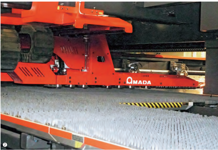
①レーザ加工中に、ワーク搬出のスタンバイをする ACIES の TK (テイクアウトローダー) / ② TK がワークを自動搬出してパレットに整列積載する / ③金型のデジタル管理を可能にする ID 金型 300 本を保有・運用するラックモジュール / ④ ACIES で加工後のブランク材 10 枚。プレス金型並みの精度を実現した
