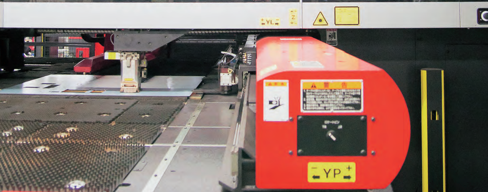
パンチ・レーザ複合マシン ACIES-2512T (棚・TK 付き) によるレーザ加工
