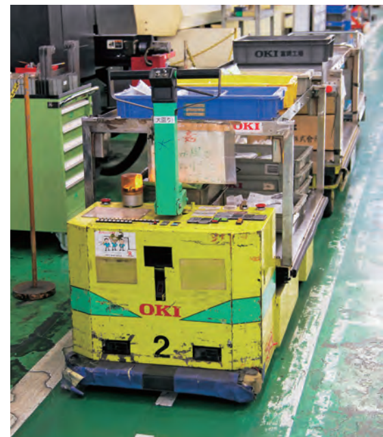
部材の無人搬送車(AGV)。同工場では徹底的な自動化を推進している
