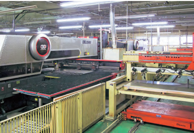
パンチ・レーザ複合マシン EML-3510NTP (棚・TK 付き) が 2 台並び、自動倉庫 MARS と連動する
