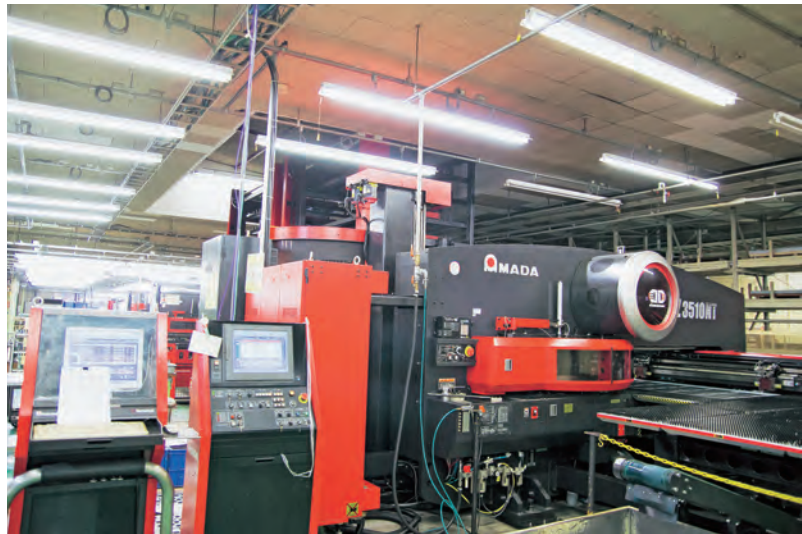
パンチングマシン EMZ-3510NTP (棚・マニプレータ付き) と EM-2510NT (棚・TK 付き) が並ぶパンチングライン
