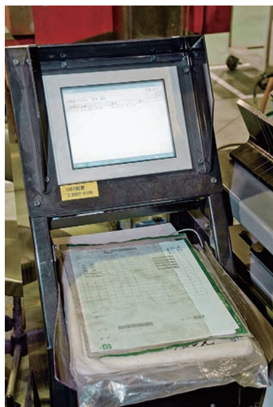
工程の実績収集を行う現場端末。ICタグ入りの作業指示書をリーダーの上に置くことで実績を収集する
