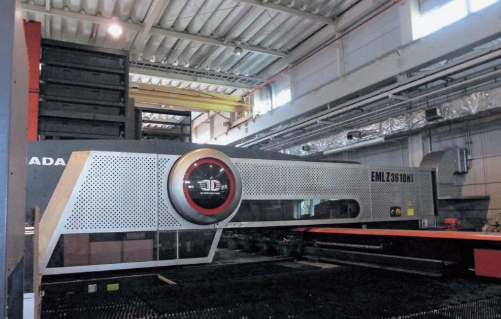
パンチ・レーザ複合マシン EML Z-3610NT+MJC
