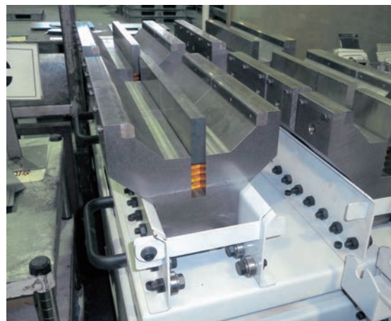
R曲げを行うための特型。エルゴノミクス、エコロジー、ユニバーサルデザインの視点からR形状が増えている
