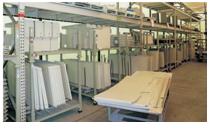
塗装後の部材。必要な部材を台車に積載し、オークマの可児工場の組立工程へと搬送する
