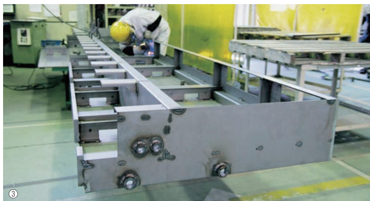
①自動溶接ロボットによる溶接作業／②共通のプラットフォームを構築することでオークマの設計部門が作成した3次元モデルをダイレクトに受け取ることができる／③工作機械用「踏み台」の溶接工程
