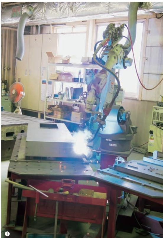
①自動溶接ロボットによる溶接作業／②共通のプラットフォームを構築することでオークマの設計部門が作成した3次元モデルをダイレクトに受け取ることができる／③工作機械用「踏み台」の溶接工程
