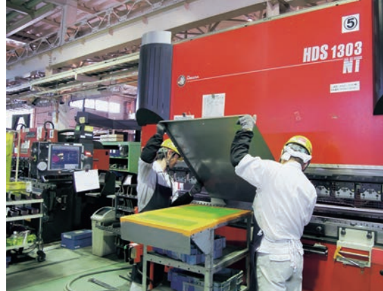
Bi-J(自動曲げ角度補正システム)を装備したHDS-1303NTによる曲げ加工
