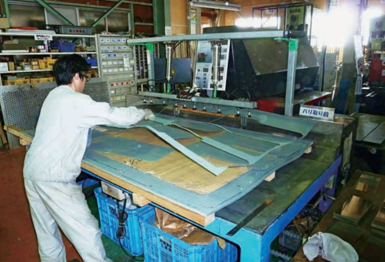
マイクロジョイントバラシ装置。自社でリフター部分の設計・製作を行った
