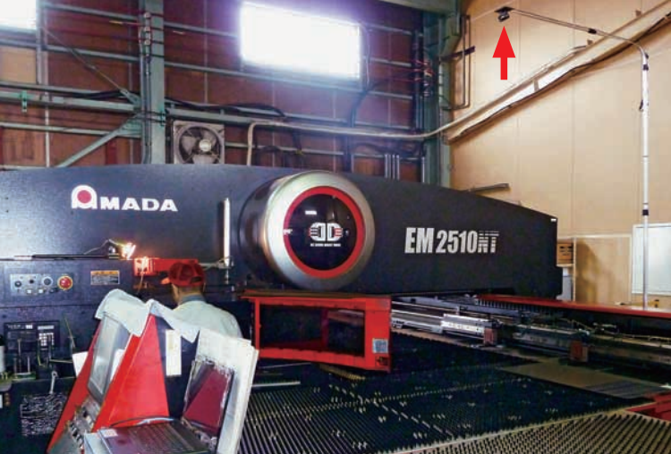
EM-2510NT にも残材を画像認識する Web カメラを設置 (矢印部)
