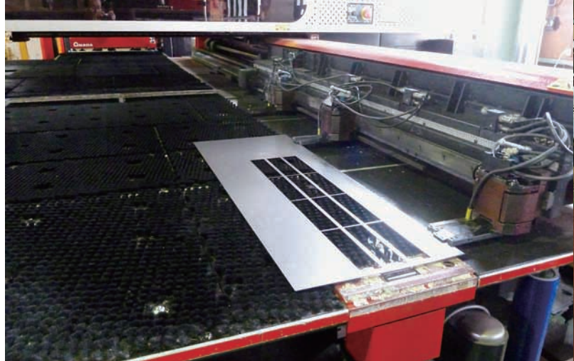
EML の加工テーブル上に、加工後の残材がクランプされている
