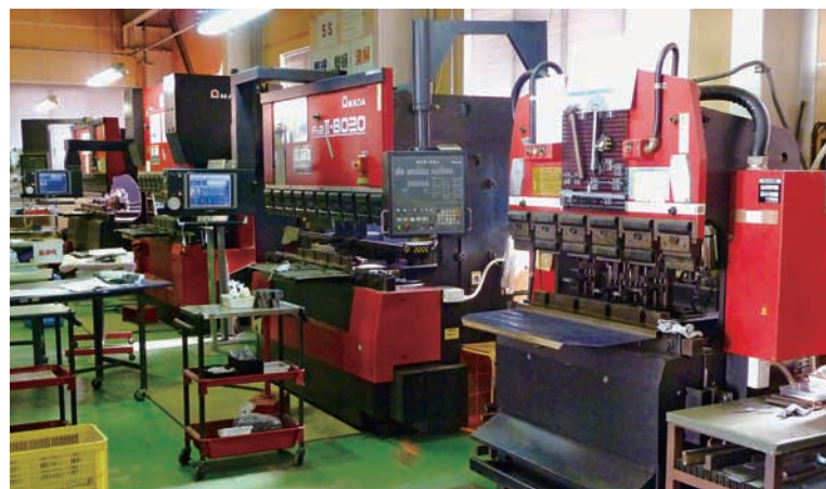
HDS-5020NT、FBDⅢ-8020NTなどが並ぶ曲げ加工エリア
