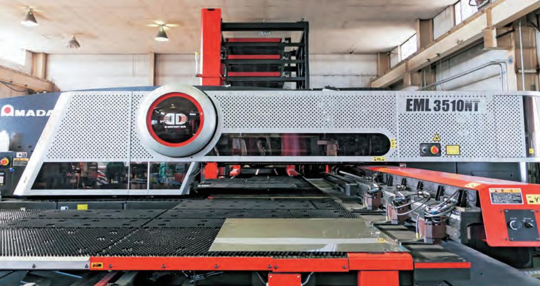
昨年9月に導入したパンチ・レーザ複合マシンEML-3510NT(棚付き)。併せて導入したブランク加工データ作成全自動CAM Dr.ABE\_Blankとともに生産性の大幅アップに貢献している
