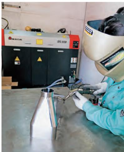
昨年 12 月に導入した YAG レーザ溶接機（ハンドタイプ）YLM-500P II
