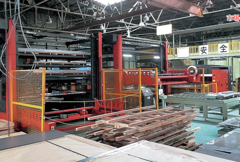
24時間稼働で生産性アップに貢献するパンチングマシン EMZ-3610NT+ULS-510+AS-510RM
