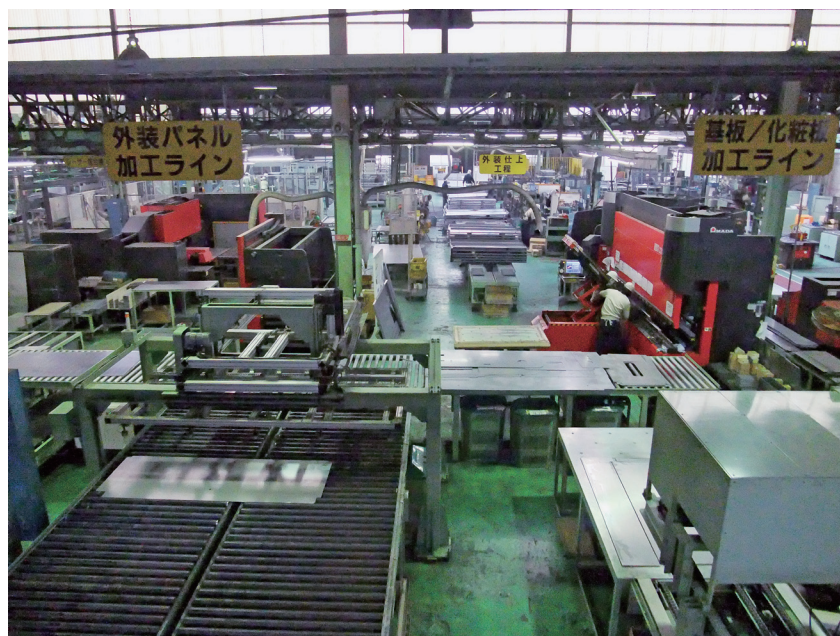
手前のブランク加工ラインで加工されたブランク材が、奥の曲げ工程へとコンベアで搬送される。右が長尺ものの曲げに対応する追従装置付きのベンディングマシンHDS-2204NT
