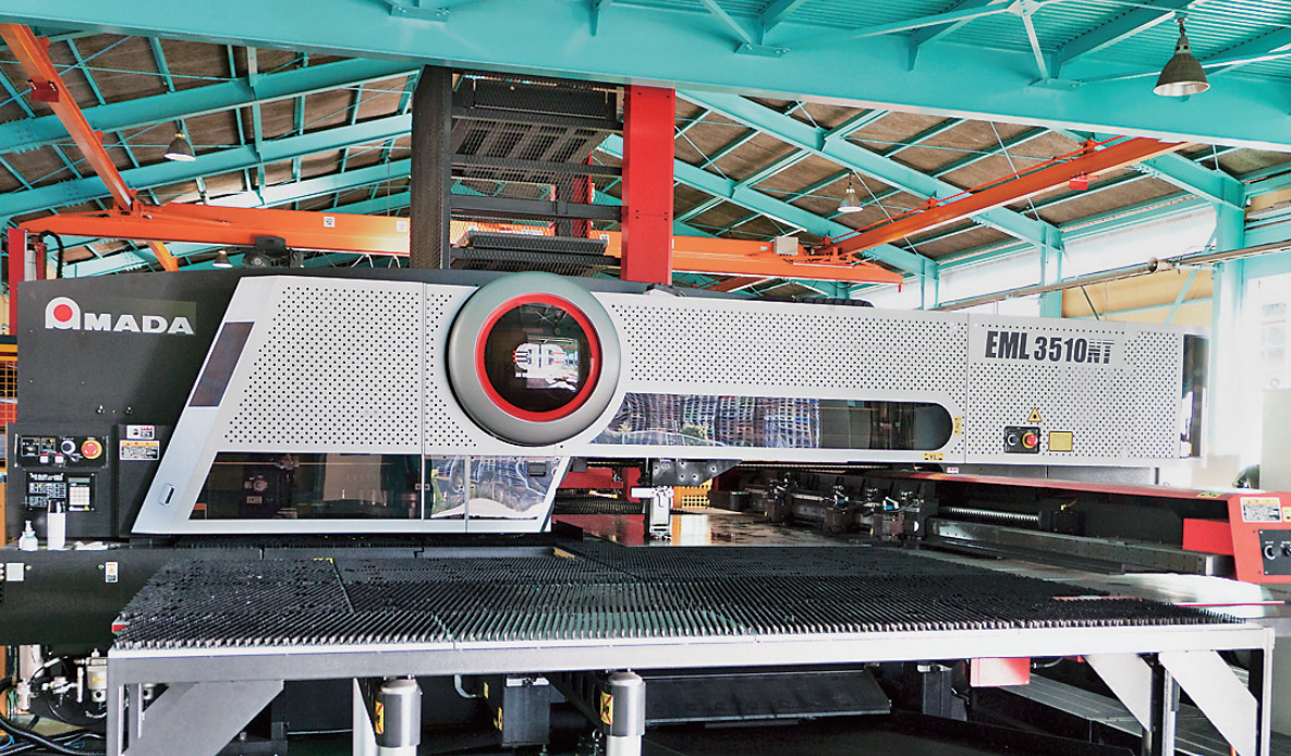
ブランク工程の工数削減を目指し、2011年8月に導入したパンチ・レーザー複合マシン EML-3510NT+ASR-48M (MJC)
