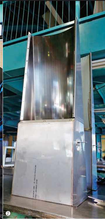
①工作機械カバーのTIG溶接を行う。極力、歪みが出ないように溶接順序などでノウハウを活かし、歪み取りに工数を取られないよう工夫している／②ステンレス製の切粉シューター
