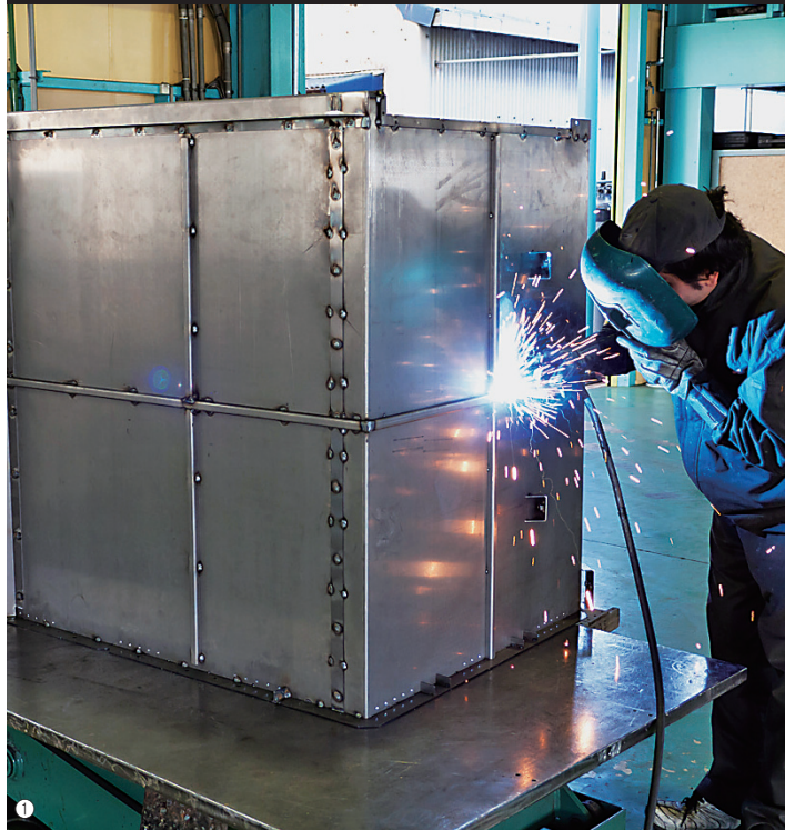
①工作機械カバーのTIG溶接を行う。極力、歪みが出ないように溶接順序などでノウハウを活かし、歪み取りに工数を取られないよう工夫している／②ステンレス製の切粉シューター
