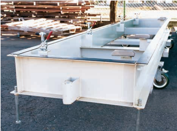
工作機械カバーの輸送治具。製品すべてに治具を用意することはできないため、サブアッシーまでの対応を提案している
