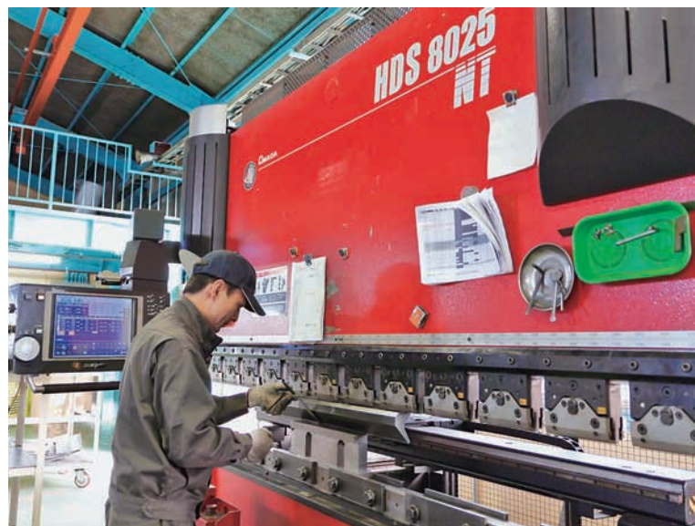
新工場移転に際して導入したベンディングマシン HDS-8025NT
