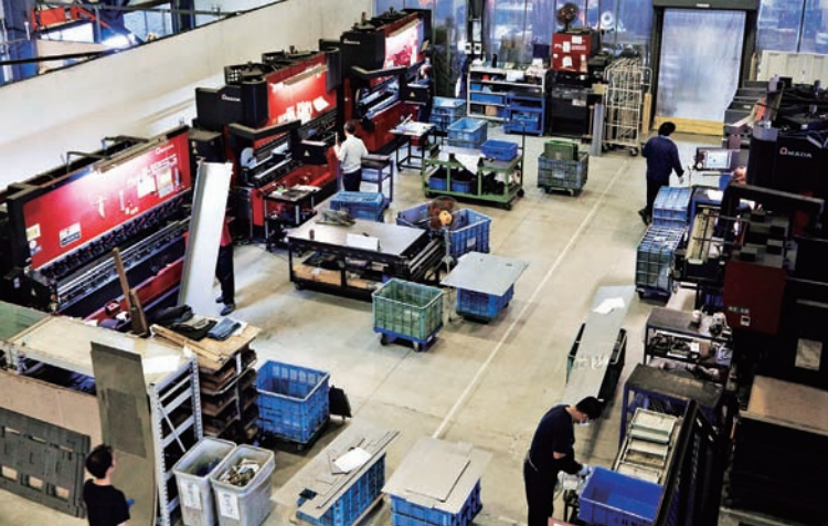
曲げ工程。HDS-8025NT × 3 台など、計 10 台のベンディングマシンで小物から大物まで対応する
