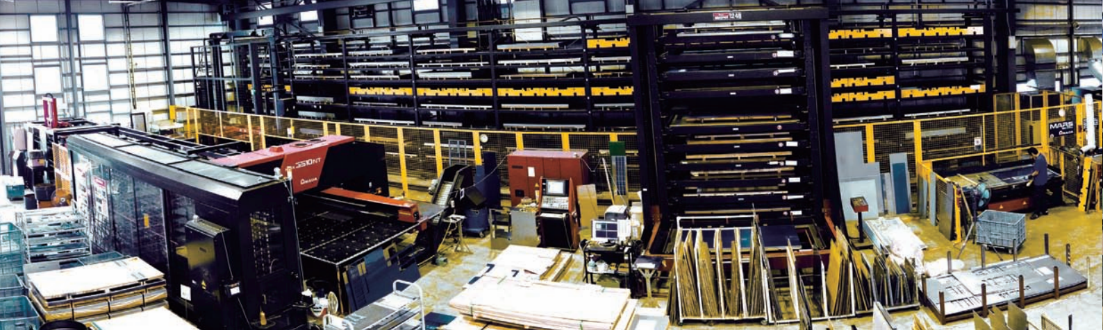
ブランク工程の主力、HMX-3510NT。241本の金型自動交換装置、インテリジェント自動倉庫 I-MARS (9列8段)と連動している
