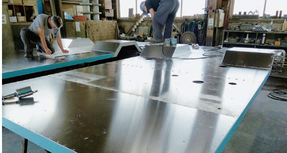
移動電源車の荷台に各種パーツをボルトで組み付ける
