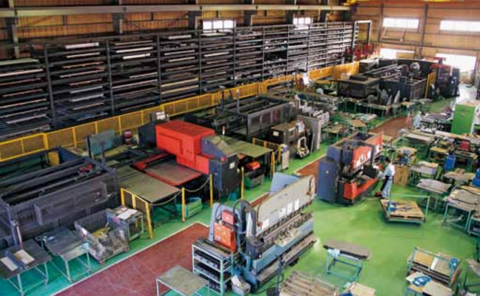
同社・富浦工場内の様子。手前は曲げ加工エリア。壁際に自動倉庫 MARS が設置され、それに沿って EML-3610NTP (奥)、COMA-567 (手前) が並ぶ
