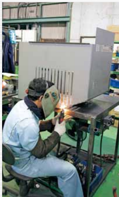
射出成形機カバーの溶接・組立を行う岩井工場では、夜間まで作業が続いていた
