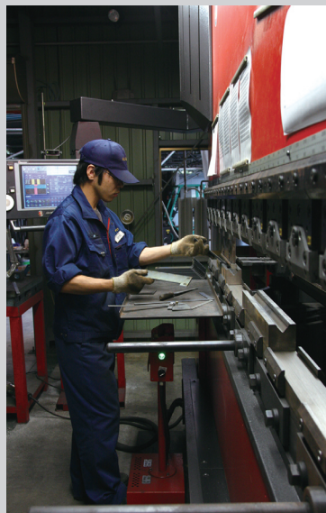
Dr.ABE_Bendが作成した曲げ加工データ呼び出して加工を行う
