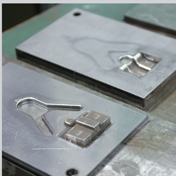
量産モノには簡易金型を起こして生産する
