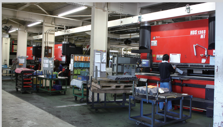
HDSが3台並ぶ曲げ工程
