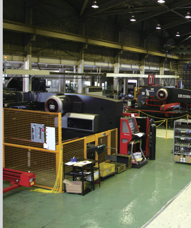
EML-3510NT+ASR-48M+TKと EM-2510NT+ASR-48M 2台が並ぶ工場内
