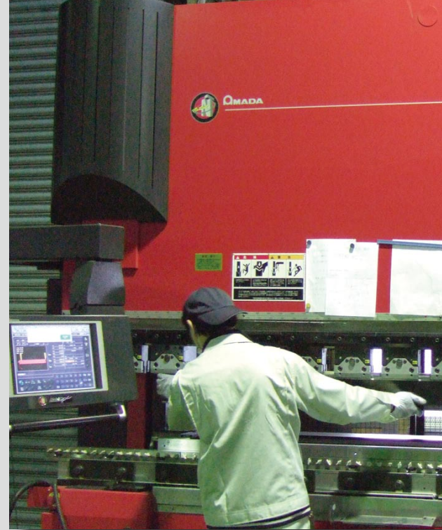
HDS-1303NTによる曲げ加工。
