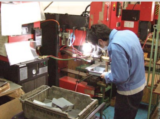
直流スポット溶接機ID-II 40HDで手際よく溶接する技術者。
