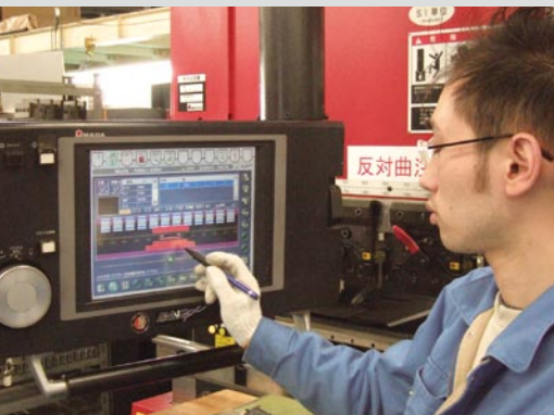
FBD III - 8025NTのAMNC/PCの画面で曲げ加工データを確認する。
