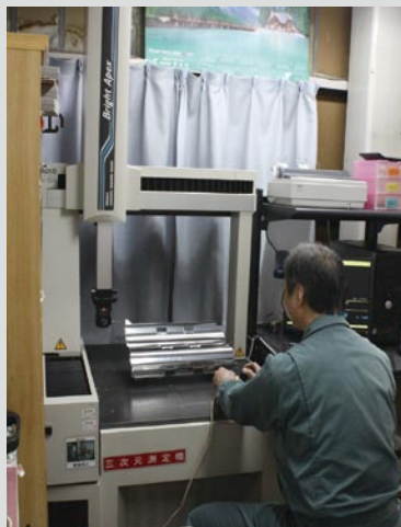
3次元測定器で製品検査を行う。
