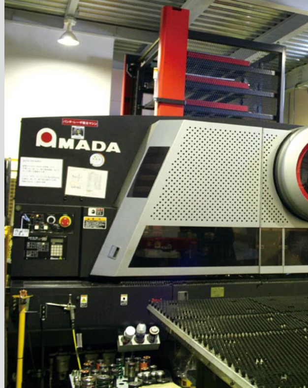
棚付き・TK付きで24時間稼働に対応する EML-3510NT+ASR-48M+TK。
