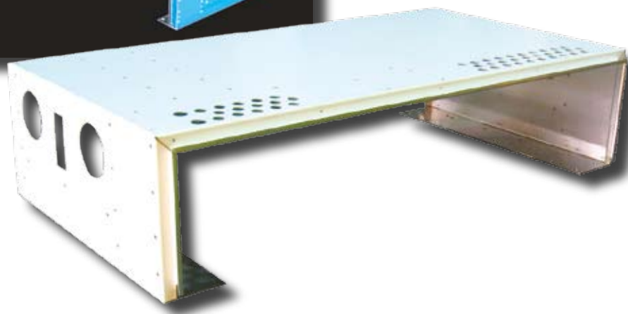
食品機械用の制御ボックスの立体姿図(左)と 立体姿図どおりに加工された食品機械用制御 ボックスのステンレス筐体(下)。
