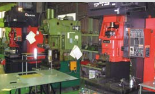
試作を板金で加工した後、量産加工は型化してプレス加工に対応する。
