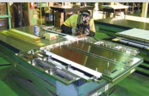
溶接工程はTIG溶接が多い。
