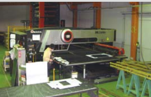
パンチ・レーザ複合マシンEML-3510NT+ASR-48M+TKは24時間稼働に対応。
