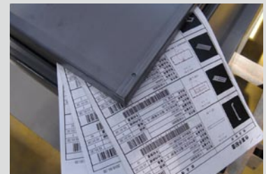
仕掛品には立体姿図が印刷された作業手配書が添付されて各工程を回る。
