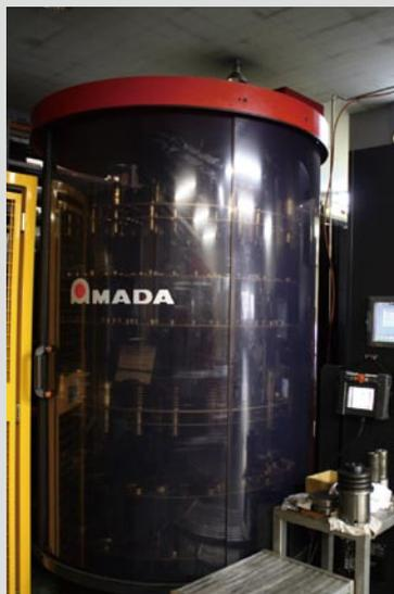
EML-3510NTPの自動金型交換装置。
