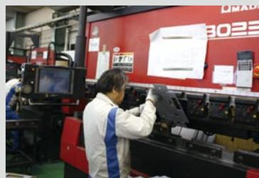
FBDⅢ-8025NTのAMNC/PCで曲げ加工データを呼び出して曲げ加工を行う。
