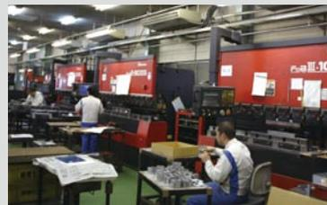
ベンディングマシンFBDⅢ-8025NT 2台などが並ぶ曲げ工程。
