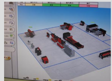
vFactory で工場内設備の稼働状況を管理する。
