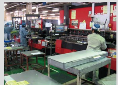
曲げ工程には2台のHDS-NT、3台のFBDⅢ-NTが導入されている。
