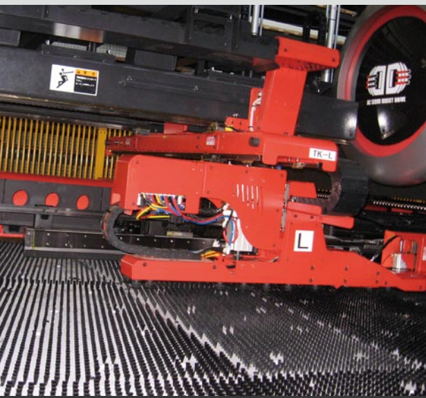
EMZで加工された製品は加工後にジョイントが切断されテイクアウトローダーが機外に搬出、パレットに整列・積載する。
