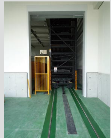
12段11列の自動倉庫MARSに材料を提供する場合は工場外まで出てくる材料パレットストッカーに材料を積載して搬入する。
