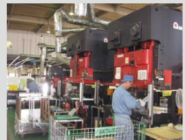
ロットが3桁を超えるとプレスで加工が行われる。
