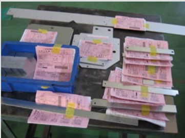
HMX・EMZで加工された製品は積載用パレットから後工程の着手日を基に後工程に送り出される。
