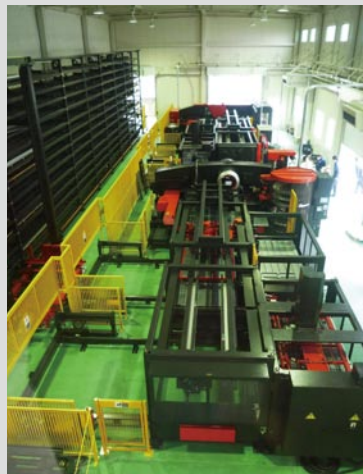
昨年完成した自動化工場ではシングルパンチプレスHMX-3510NT+SR-48RM+LA-48RM(奥)とパンチングマシンEMZ-3510NT+PDC+ASR-48RM+LA-48RM(手前)が自動倉庫MARSと連動する。
