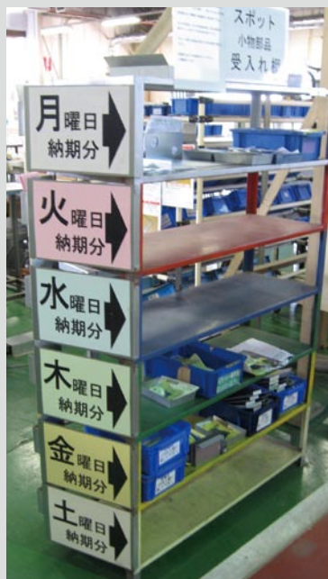
加工が終了した仕掛品は次工程の投入予定日に対応してパuffer用の棚に整理整頓して格納される。作業指示書も1週、6色で識別できるように色分けされている。
