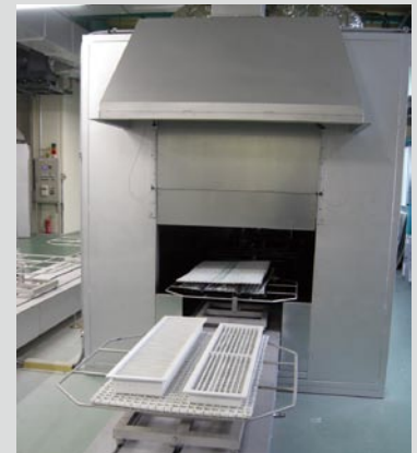
全自動塗装システムで自動焼付塗装を行なう。
