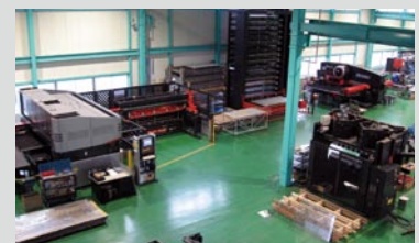
新工場に導入されたLC-2012C1NT、EM-2510NT、HDS-8025NTなどが工程順に配置されている。
