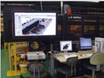
工場には稼働サポートシステムvFactoryが設置され稼働状況をリアルタイムに把握する。
