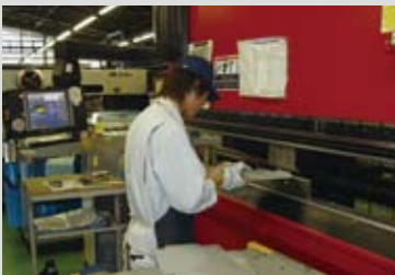
ベンディングマシンHDS-8025NTの神宮司さんは4月から担当し、リピート加工では1日あたり、2,400ショットと従来の3倍の生産性アップを達成した。
