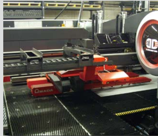
EMLで加工が終了するとテイクアウトローダーが切り離された部品を取り出しに行く。
