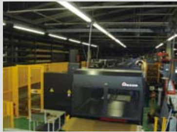
パンチ・レーザ複合マシンEML-3510NTP+SR-48RM+LA-48RM+TK+MARSは140本の金型交換装置を備えている。
