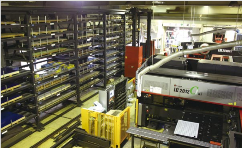
工程統合マシンLC-2012C1NTと自動倉庫MARS(5列9段)が連動している。
