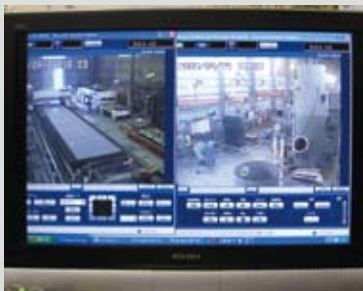
工場内の様子はwebカメラで確認する。画像が鮮明なので加工の不具合や帳票の確認ができる。
