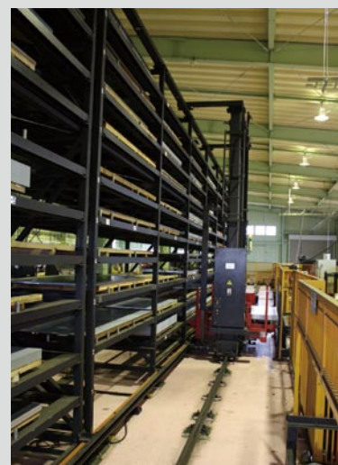
8760時間稼働に貢献する10段13列130パレットを装備した大型自動倉庫
