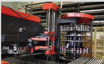
VIPROS Z-358のPDC(パンチ・ダイ交換システム)が金型の自動交換を行う。
