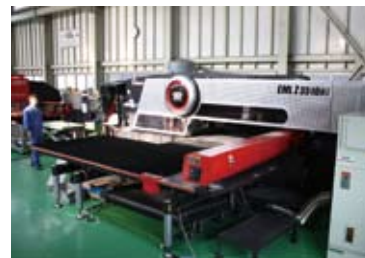
EML-3510NTではSUS304などのステンレス材の加工やタップ加工などを行う。
