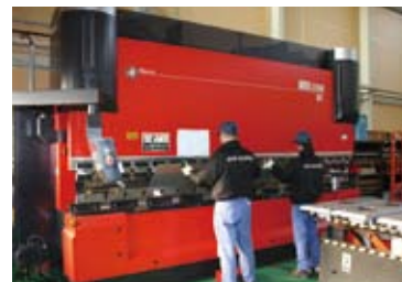
HDS-2204NTによる長尺曲げ。製品が大型化して装置関連の部材には長尺製品の加工が増えている。
