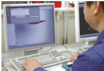
3次元ソリッド板金CAD、SheetWorksで発注元から送られてきた3次元製品モデルから板金属性を再定義して展開作業を行う。
