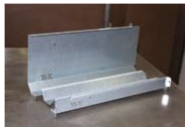
多工程連続曲げ加工で完成した製品。中曲げや、切り起こしを含めると50工程を超える工程数の製品もある。
