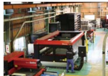
LC-3015F1NT+LST-3015F1では0.8mmの薄板から16mmまでの厚板を切断する。
