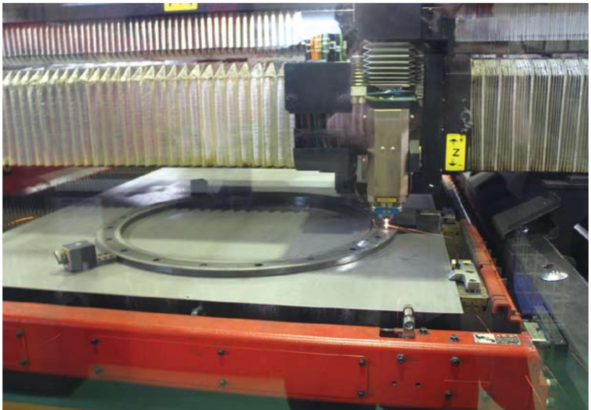
LC-3015F1NTで従来は機械加工されていた装置部品に使われる板厚16mmの製品を加工する。
