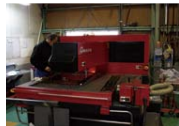
パイプインデックス装置を装備したレーザマシン、Quattroではパイプの加工やプレス加工で成形された製品に追加工などを行うため使用している。
