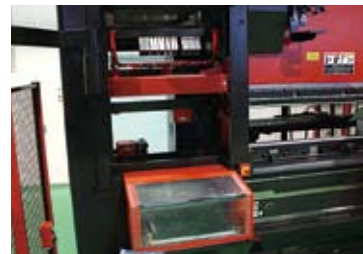
ASTRO II-100NT(CELL)は大容量新型ATC機構を装備し、パンチ14、ダイ17の金型を保有できる。
