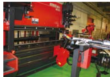
ASTRO II-100NT(CELL)の自動グリッパー交換装置は最大6種類のグリッパーを搭載できる。
