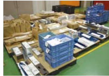
曲げ加工が終了した製品はバーコード付きの作業指示書とともに、次工程の組立工程行きのパufferコーナーに仕掛かり品として集積される。
