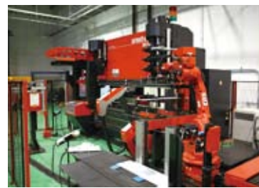
新工場へ移転後1番に導入されたペンディングロボットASTRO II-100NT(CELL)。
