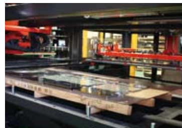
EML-3510NTのテイクアウトローダー(TK)で集積用のパレットに整列積載された加工済みのブランク材。
