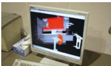
ベンディングロボットASTRO II-100NTシリーズ用に曲げデータとロボットの動作プログラムをオールインワンで作成するDr.ABE_ASTRO。
