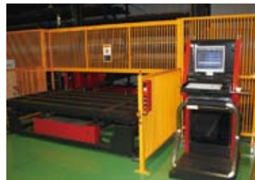
自動倉庫MARS 8列 10段の搬入出口とFMSコントローラー。
