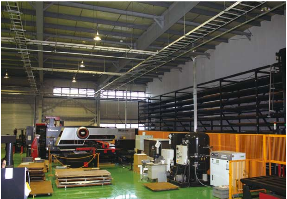
パンチ・レーザー複合マシンEML-3510NTは抜き、タップ、成形などの工程を統合して時短に貢献する。
